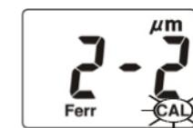
3. 将仪器传感器正好贴在金属校准垫片没有覆盖的一面。等待一会儿，直到听到 2 个信号声，屏幕上出现 “2-2”，然后拿开仪器。（仪器自动脱离表面）。
