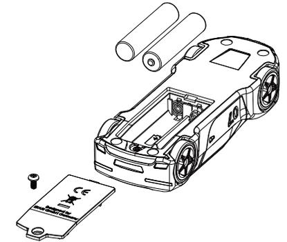
1. La energía del dispositivo es proporcionada por 2 pilas de 1,5 V (AAA).
