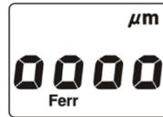
La función Reset/Autocalibración se utiliza para restablecer el dispositivo a la configuración de fábrica y le permite detectar con precisión las diferencias de espesor de la pintura en diferentes partes del cuerpo del vehículo con precisión, y el dispositivo no necesita ser calibrado.
