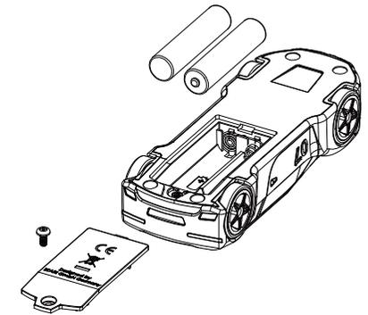
1 L'alimentation énergétique de l'appareil se fait avec 2 x batteries 1,5 V (AAA).
