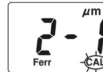
3. Appuyez le capteur de l'instrument exactement contre la face non revêtue de la rondelle métallique d'étalonnage. Attendez jusqu'à ce que vous entendiez deux bips et l'écran affiche « 2 - 2 », puis, retirez l'instrument de la rondelle. (Ce faisant, l'instrument sera automatiquement calibré à la surface sans revêtement).
