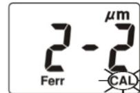
4. Placez la plaque d'étalonnage en plastique d'épaisseur standard de 102 microns sur la face non revêtue de la rondelle métallique d'étalonnage.
