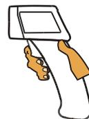
2. Drücken Sie das Messgerät gerade und fest auf die zu prüfende Oberfläche. Ziehen Sie den Abzug und lassen sie ihn sofort wieder los. Wenn die Messung abgeschlossen ist, ertönt ein „Beep“.
