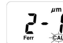
2. Pritisnite i držite tipku "CAL" dok ne čujete zvučni signal, na zaslonu se pojavljuje „2 – 1“ i treperi simbol "CAL".
