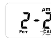
3. Pritisnite senzor uređaja ravnomjerno na nepokrivenu stranu metalne kaliracijske podloške.
