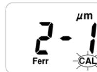
3. Appuyez le capteur de l'instrument exactement contre la face non revêtue de la rondelle métallique d'étalonnage.
