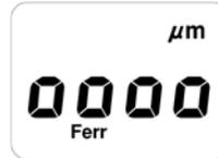
**La función Reset/Autocalibración se utiliza para restablecer el dispositivo a la configuración de fábrica y le permite detectar con precisión las diferencias de espesor de la pintura en diferentes partes del cuerpo del vehículo con precisión, y el dispositivo no necesita ser calibrado.**
