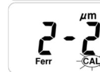
4. Coloque la película de espesor estándar con el espesor estándar de 102 micrómetros en el disco de calibración no recubierto.
