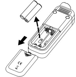
1. Die Energieversorgung des Gerätes erfolgt durch 2 x 1,5 V-Batterien (AAA).
